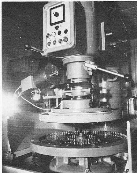
Auf der Doppel-Läppmaschine werden gleichzeitig 160 Kernpakete beidseitig exakt planparallel auf genaues Dickenmass geläppt. Die Zuverlässigkeit der Kopffertigung ist nur gewährleistet, wenn hier Toleranzen von wenigen Tausendstelmmillimetern eingehalten werden.
