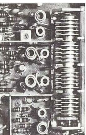
② Hochleistungs-HF-Eingangsteil mit 3 Feldeffekt-Transistoren und 4-fach-Drehkondensator-Abstimmung.
