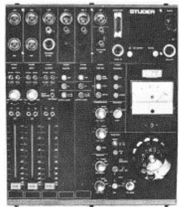
Studer 069, Reportageeinheit für Rundfunkübertragungen «im Felde» via Telefonleitungen.
