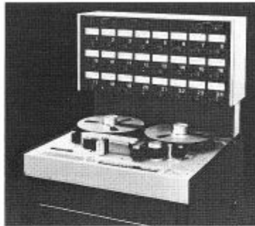
Studer A800, Studio-Mehrspurtonbandmaschine. Mikroprozessorgesteuert, sehr reaktionsschnell, für den Betrieb mit VTR über Tape-Lock-System 2000 bestens geeignet.
