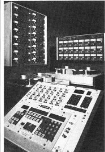
Studer-Fernsteuersysteme für moderne Tonbandmaschinen: Tape-Lock-System 2000 für elektronische Synchronisation und elektronisches Editing, Audiokanalfernsteuerung und Autolocator mit 20 speicherbaren Bandadressen.
