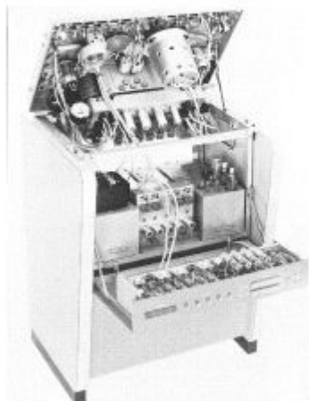
Präzisionsmechanik und Elektronik in bester Harmonie! Der Einblick in das «Innenleben» des 4-Kanal-Studiotonbandgerätes Studer J37.
