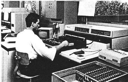
Das modernste In Circuit Testsystem im Baugruppenprüffeld Regensdorf im Einsatz
