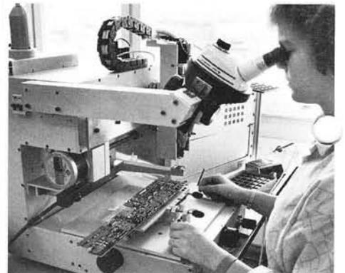
Fraulein Dickert an der Impulsstempelmaschine. Durch das Mikroskop kontrolliert sie die Qualität der Lötstellen.
