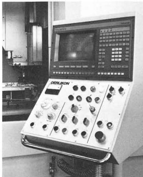
Auf einem schwenkbaren Bedienpult befindet sich die CNC-Steuerung.
