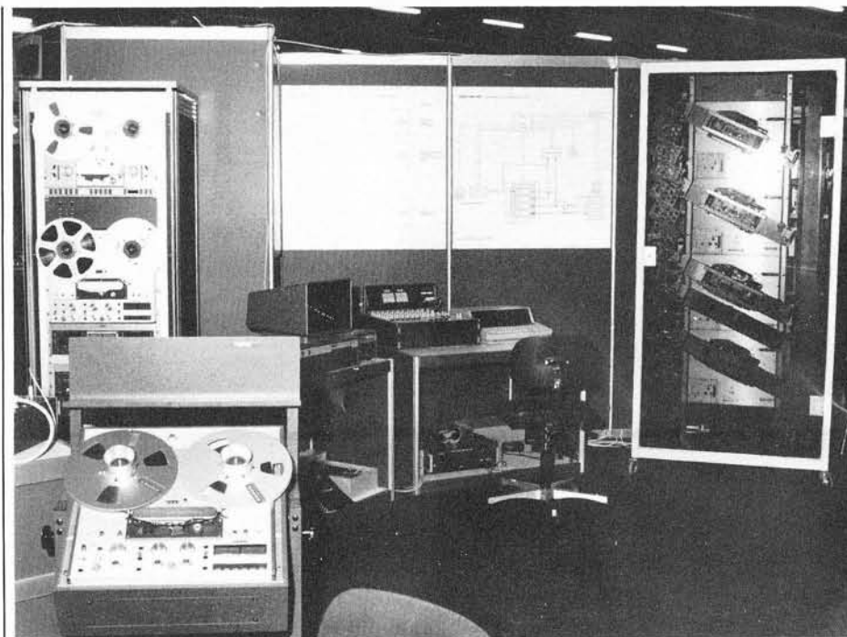
Ansicht D: Der CAMOS Spielerturm komplett mit dem übergeordneten Rechnersystem. Links die PR99 in der Rack- und Konsolenversion.
