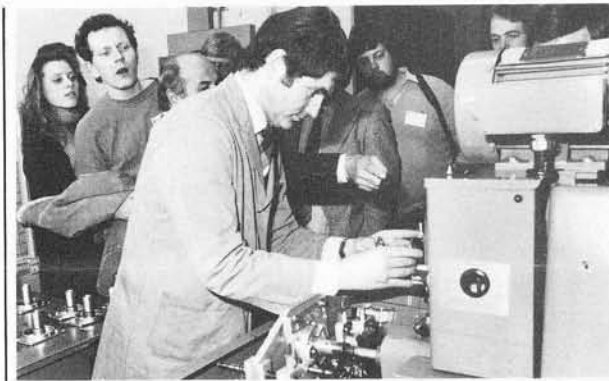
Wickelmotorflanschen in Bearbeitung auf der Honmaschine mit automatischer Messsteuerung. Martin Flühmann am Innenmessgerät.
