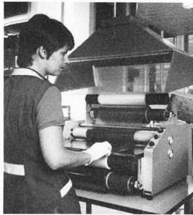
4. Im vollklimatisierten, vor UV-Licht geschützten Teil werden die diffizilsten Arbeitsgänge vorgenommen. Im Vordergrund die Anlage zur Beschichtung von doppelseitigen Leiterplatten mit Fotoresistfolien.
