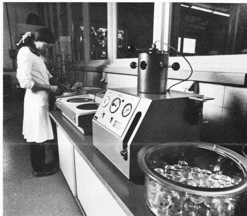
21. Im Chemielabor werden neben Analysen auch täglich Schliffbilder herge- stellt. Im Vordergrund die Wärmepresse für das Eingießen der Schliffpro- ben.
