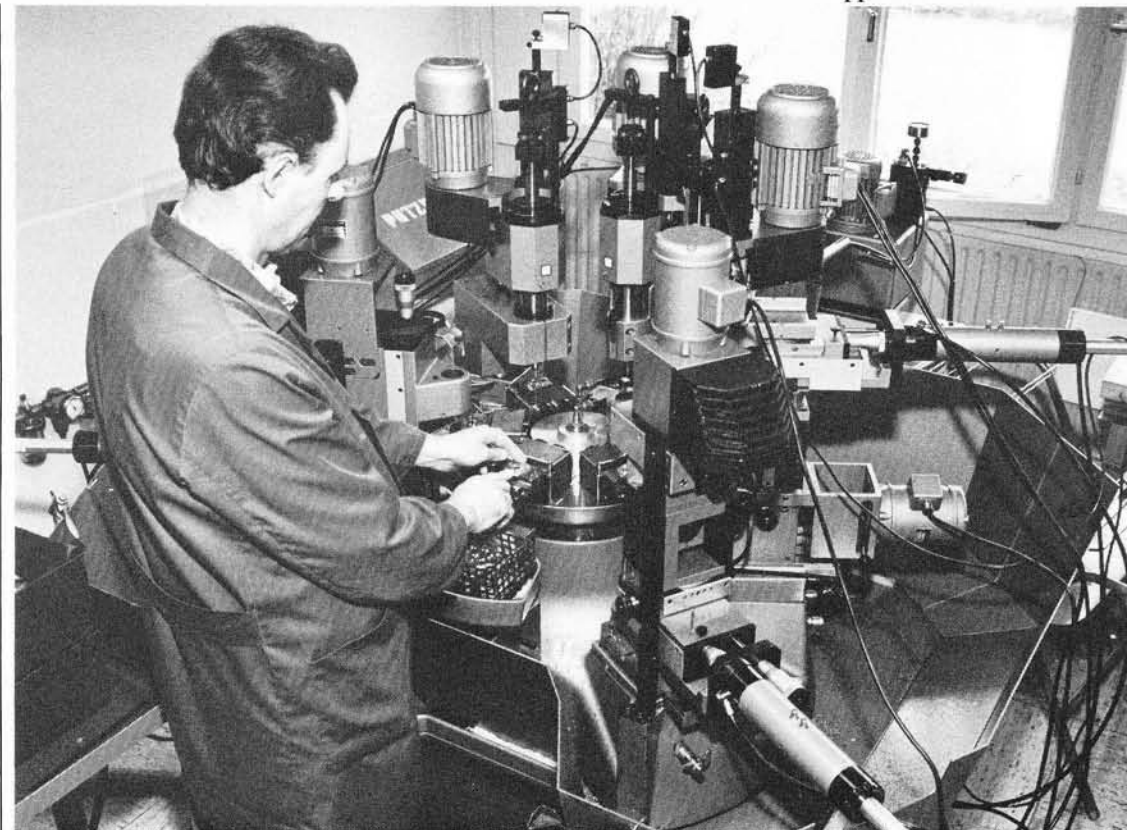
17. Laufwerkeinbau in das fertige Chassis.
