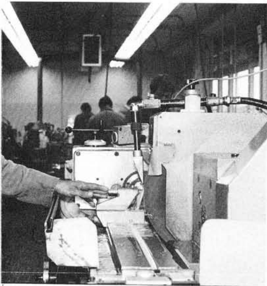
12. Das eingelaufene Motorteil wird auf einem speziell dafür umgebauten PR99 auf seine Gleichlaufeigenschaften überprüft.
