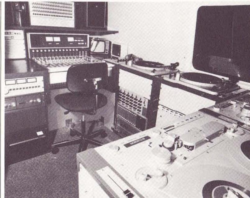
STUDER A80/RC Tonbandmaschinen und EMT Plattenspieler
